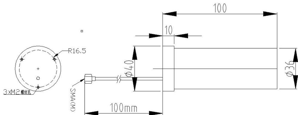
图1 天线结构尺寸图
